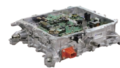
车载充电器、 DC-DC转换器 一体单元
