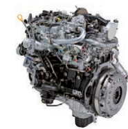
1GD-FTV型 排气量2.8L 搭载于兰德酷路泽普拉多车、 搭载于HIACE
