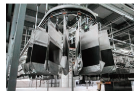
VANDERLANDE 垂吊式高速分拣系统 POCKET SORTER
