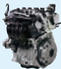
M20A-FKS型ガソリンエンジン (排気量2.0ℓ、RAV4、カローラスポーツ搭載)
