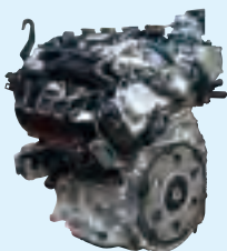
A25A-FKS型ガソリンエンジン (排気量2.5ℓ、RAV4搭載)
