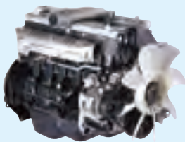
1HZ型ディーゼルエンジン (排気量4.2ℓ、ランドクルーザー搭載)
