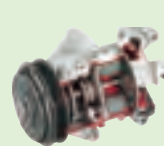
5S10 コンプレッサー (斜板式クラッチレス 外部可変容量)
