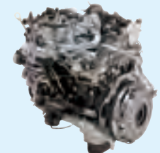
1GD-FTV型ディーゼルエンジン (排気量2.8ℓ、ランドクルーザープラド、 ハイエース搭載)
