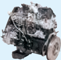
2KD-FTV型ディーゼルエンジン (排気量2.5ℓ、ハイエース搭載)
