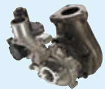
TIA型可变喷嘴式涡轮增压器
