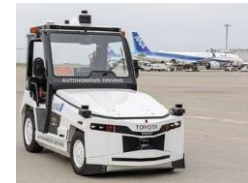
①空港制限区域内における自動運転トーイングトラクター（開発中）
