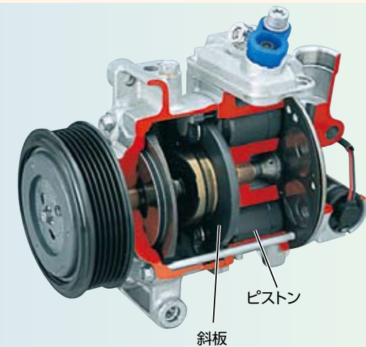
斜板の角度を変えることで、ピストンのストロークを調整し、冷却能力を自動制御
