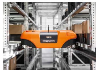
シャトルタイプ自動倉庫
