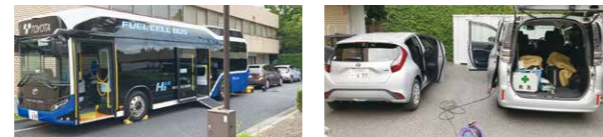
電動車を非常用電源の一部として活用する訓練
