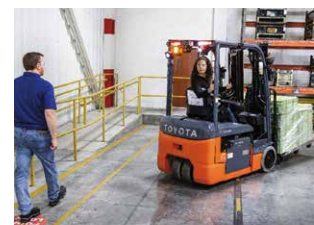
オペレーター支援機能などを追加した3輪電動フォークリフト
