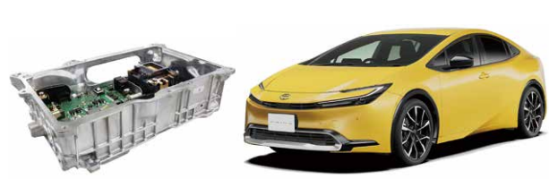
左：新開発の小型・大電流のハイブリッド車用DC-DCコンバーター 右：トヨタ新型「プリウス」
