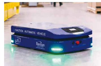
Bastian自社開発ミニローダー (自律移動型ロボット)
